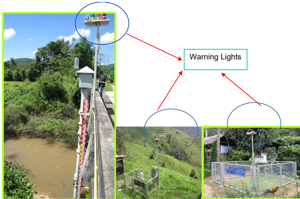
รูปที่ 6.26 สถานีเตือนภัยอัตโนมัติที่ใช้ข้อมูลการไหลของน้ำและปริมาณน้ำฝน (การติดต่อสื่อสารส่วนตัว, ทน.)
